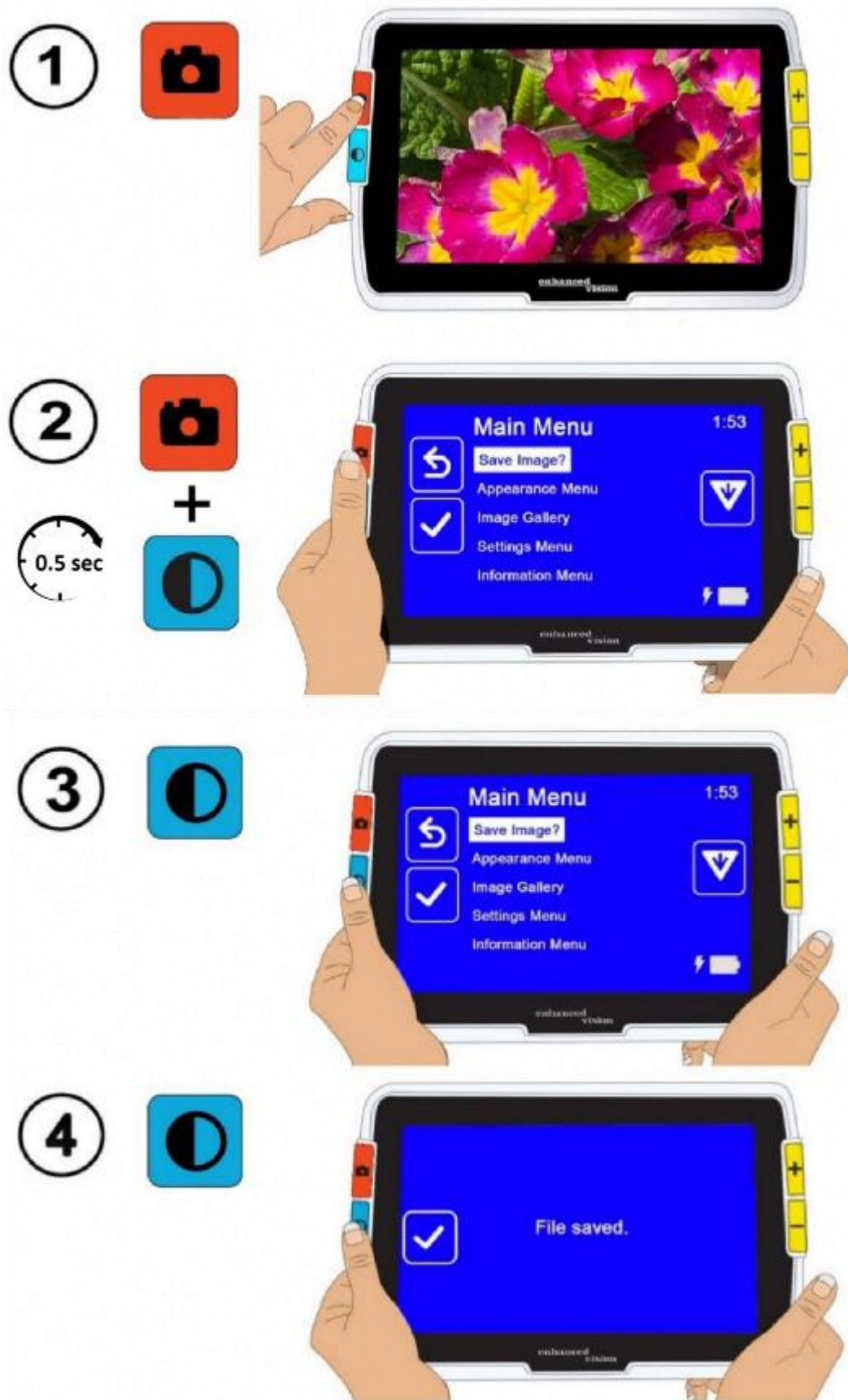
Rys. Kolejne etapy wykonywania zdjęcia, wyświetlenia Menu głównego, wybrania opcji Zapisać zdjęcie? i zapisania zdjęcia do pliku.
